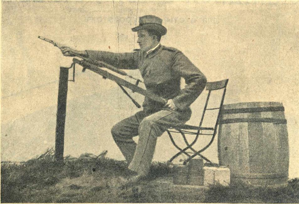
для стрѣльбы по асфальтовымъ тарелкамъ, заслуживающій по простотѣ конструкции, простому съ нимъ обращенію и дешевизнѣ всеобщее вниманіе. Это первый метательный приборъ, установленный не на тяжеломъ желѣзномъ треножникѣ, а на простомъ, крѣпкомъ, деревянномъ брускѣ, прикрѣпленномъ впереди къ желѣзному стержню; бруску этому при метаніи можетъ быть дано любое направленіе. Всѣ желѣзные части этого аппарата крайне просты, прочны и въ случаѣ надобности могутъ быть легко замѣнены.
