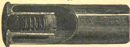
Для предупрежденія поломки ударниковъ при спускѣ бойковъ у безкурковыхъ ружей весьма рекомендуемъ пользоваться специальными, такъ называемыми ударными гильзами. Ударникъ при пользованіи этими гильзами ударяетъ въ каучуковый буферъ, помещенный въ концѣ сильной пружины, чѣмъ ослабляется ударъ и предохраняется боекъ отъ поломки. Имѣются кал.: 12, 16 и 20. Цѣна за пару 3 руб.
