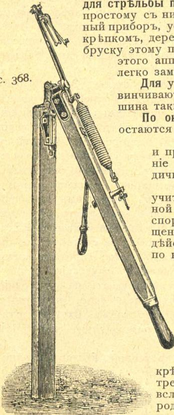
Для установленія снаряда необходимъ лишь прочный столбъ, къ нему привинчиваются двѣ петли, черезъ которыя продвѣается стержень — и вся машина такимъ образомъ установлена.
