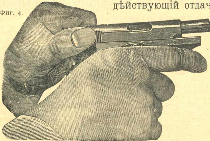
жину и ударникъ. Возвращаютъ на мѣсто оттянутую часть пистолета, возвратнымъ движеніемъ которой патронъ вкладывается въ стволъ (фиг. 4).
