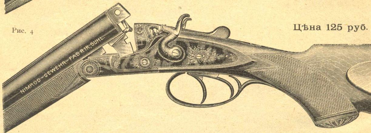
Рис. 3. Двухствольное дробовое ружье завода „Нимродъ“ въ Зулѣ. Затворъ тройной съ поперечн. болтомъ Гринера. Рычагъ между курками. Стволы стальные. Калибръ 12-й. Правый стволъ цилиндръ, лѣвый „Чокъ“. Курки возвратныя. Ложа пистолетная изъ хорошаго орѣха. Цѣвье пружинное. Замки изящно гравированы. Длина стволонъ 16—17 верш. Вѣсъ ружья около 7½ ф. Отдѣлка всего ружья солидная и красивая. Къ ружью прилагаются пробные листы съ указаніемъ заряда пороха и дроби. Цѣна 85 руб.
