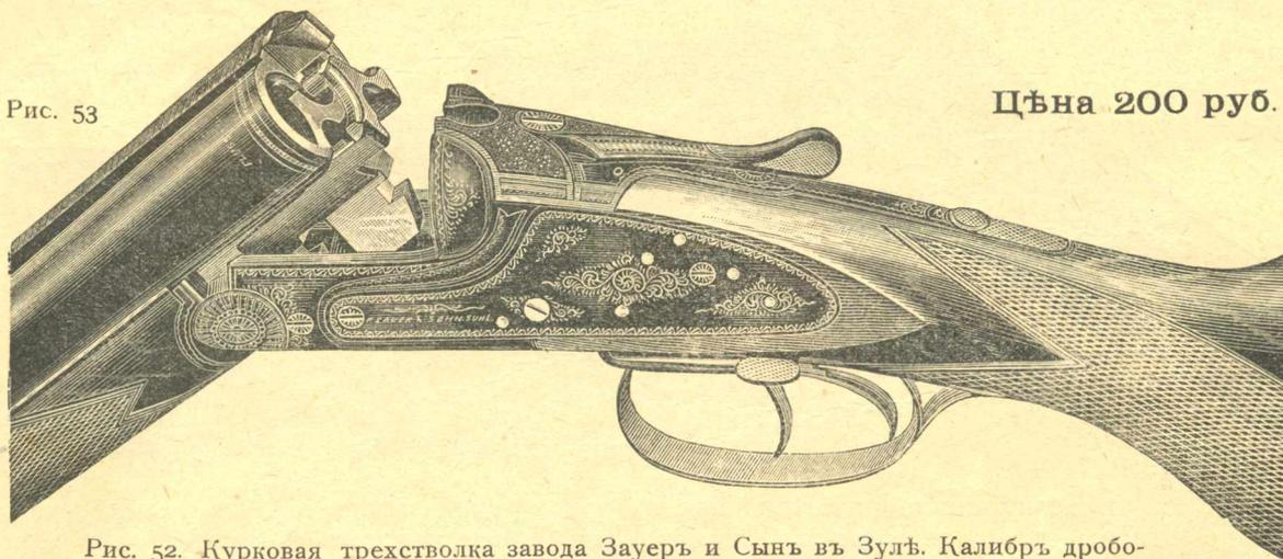
Рис. 52. Курковая трехстволка завода Зауеръ и Сынъ въ Зулѣ. Калибръ дробовыхъ стволовъ 12-ый. Пульный стволъ кал. 8 м/м. Стволы изъ Крупновской стали. Затворъ тройной съ рычагомъ подъ скобой. Курки возвратные. Цѣвье пружинное. Ложа орѣховая съ пистолетной рукояткой и со щекой. Первый спускъ, предназнач. для праваго дробового и для пулевого ствола, имѣетъ шнеллеръ. Работа очень тщательная и солидная. Цѣна 135 руб.
