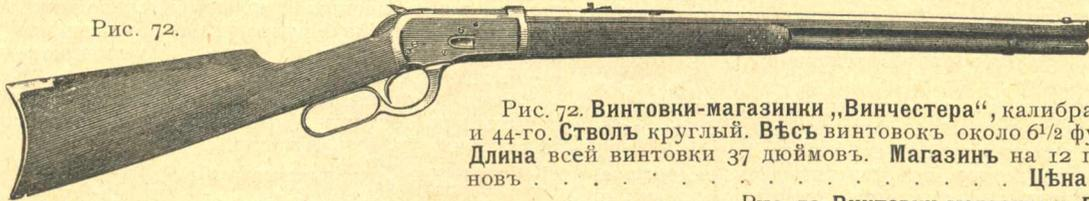
Рис. 72. Винтовки-магазинки „Винчестера“, калибра 32, 38 и 44-го. Стволъ круглый. Вѣсъ винтовокъ около 6½ фунтовъ. Длина всей винтовки 37 дюймовъ. Магазинъ на 12 патроновъ . . . . . Цѣна 40 р.
